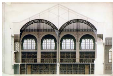
アンリ・ラブルースト、サント・ジュヌヴィエーヴ図書館（1843-1850, 51）、2階大閲覧室、断面詳細図。©BSG, BNF.
